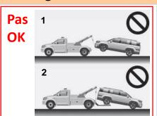
Remarque: ne remorquez pas avec une dépanneuse de type grue de levage (1). Ne remorquez pas le véhicule avec les roues avant posées sur le sol, car cela pourrait l'endommager (2).
