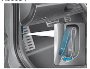
Tirez le levier de déverrouillage pour déverrouiller le capot. Le capot devrait se soulever légèrement.
