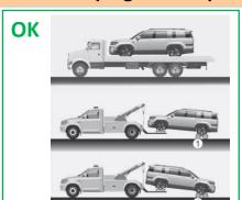
Remarque: l'utilisation de chariots porte-roues (1) ou d'une dépanneuse à plateau est recommandée. Utilisez un lève-roues ou une dépanneuse à plateau.
