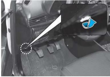
Ziehen Sie den Entriegelungshebel an, um die Motorhaube zu entriegeln. Die Haube sollte leicht aufspringen.
