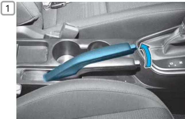
Handbremse so weit wie möglich anziehen
