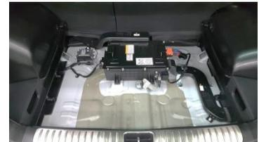
Sie finden dort den Lüftungskanal (Ein-/Auslass) und das 48V-Batteriesystem.
