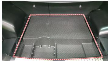
Entfernen Sie anschließend die Schaumstoffeinlage.
