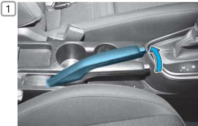
Handbremse so weit wie möglich anziehen
