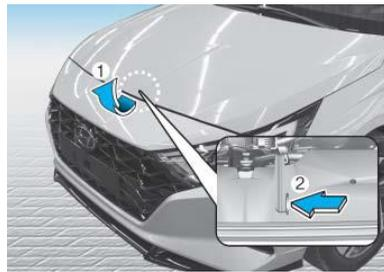
Heben Sie die Haube leicht an, drücken Sie den Fanghaken innen in der Mitte (1) nach oben und öffnen Sie die Haube (2).
