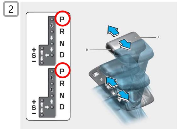
Bei Fahrzeugen mit Automatikgetriebe: Wählhebel in Position P bringen
