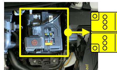
Batterie 12V dans le compartiment moteur
