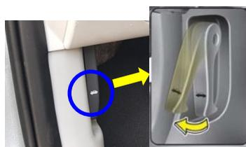
Tirer sur le levier de déverrouillage du capot. Le capot doit s'ouvrir légèrement.
