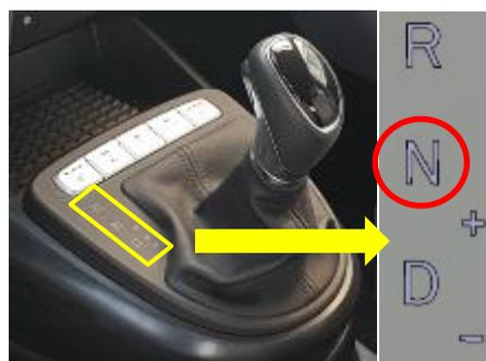
Pour les véhicules BVA (Boîte de vitesses automatique), mettre le levier de vitesse en position N.
