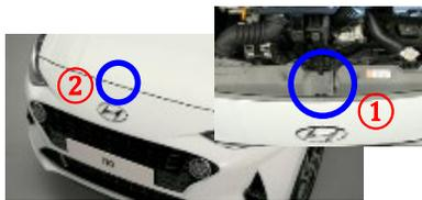
Heben Sie die Haube leicht an, drücken Sie den Fanghaken innen in der Mitte (1) nach oben und öffnen Sie die Haube (2).
