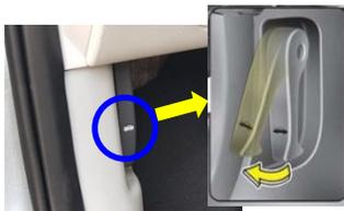
Ziehen Sie den Entriegelungshebel an, um die Motorhaube zu entriegeln. Die Haube sollte leicht aufspringen.
