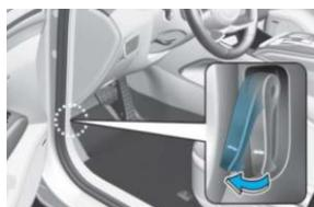
1. Tirez le levier de déverrouillage pour déverrouiller le capot. Le capot doit s'ouvrir légèrement
