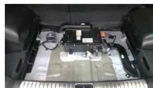
Il y a un conduit d'entrée/sortie et un système de batterie 48V.
