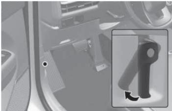
Tirez le levier de déverrouillage du capot pour déverrouiller le capot.
