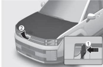
Allez à l'avant du véhicule, soulevez légèrement le capot, poussez le levier secondaire de déverrouillage du capot vers le haut (1) à l'intérieur du centre du capot et soulevez le capot (2).
