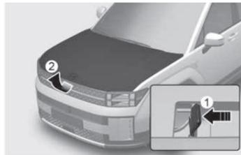
Na dianteira do veículo, levante ligeiramente o capot, empurre a alavanca secundária de libertação do capot para cima (1) no interior do centro do capot e abra-o (2).
