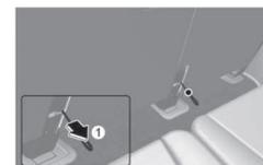
Se o interruptor de entrada não funcionar, puxe a correia (1) situada na parte inferior esquerda do banco.
