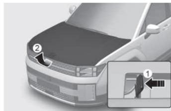
Diríjase a la parte delantera del vehículo, levante ligeramente el capó, empuje hacia arriba la palanca secundaria de liberación del capó (1) situada en el interior del centro del capó y levante el capó (2).
