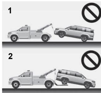
Aviso: No remolque con equipos tipo eslinga (1). No remolque el vehículo con las ruedas delanteras en el suelo, ya que podría dañarlo (2).
