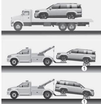
Aviso: Se recomienda el uso de plataformas rodantes (1) o plataformas planas. Utilice un equipo de elevación de ruedas o una plataforma.
