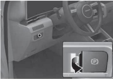
Verkeilen Sie die Räder und ziehen Sie den EPB-Schalter, um die Feststellbremse einzustellen.
