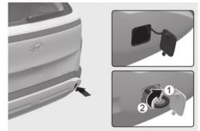
Abschlepphaken im Werkzeugkoffer in der Heckklappe
