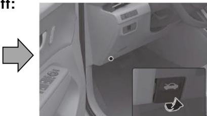
Ziehen Sie den Entriegelungshebel zur Entriegelung der Motorhaube. Die Motorhaube sollte leicht aufspringen.
