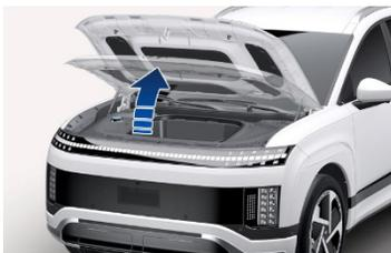
Allez à l'avant du véhicule, soulevez légèrement le capot, poussez le levier secondaire de déverrouillage du capot vers le haut à l'intérieur du centre du capot et soulevez le capot.
