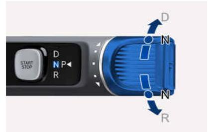
Mettez le véhicule en position P (stationnement) en appuyant sur le bouton « P » sur le levier rotatif
