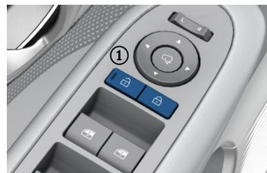
En appuyant sur le bouton (1) sur le commutateur, toutes les portes du véhicule sont déverrouillées
