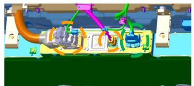
Débranchez le connecteur **haute tension HT** et **basse tension BT**.
