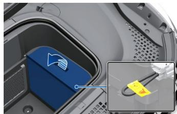
Sur cette illustration, la trappe de maintenance est située sur le côté droit. Ouvrez la trappe de maintenance et trouvez le verrouillage de service.
