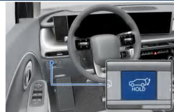
Appuyez sur le bouton d'ouverture/fermeture électrique du hayon pendant 1 seconde.
