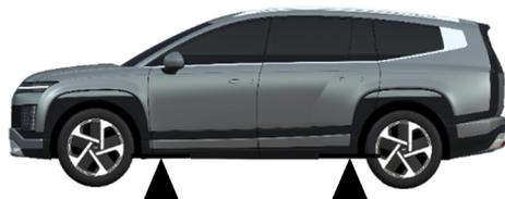
Levez la voiture pour accéder à l'emplacement de la batterie sous le plancher
