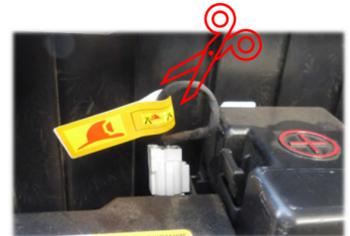
Corte o cabo do bloqueador de serviço para desativar o sistema de AT
