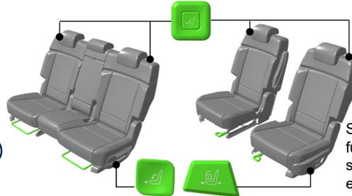
Se o interruptor de entrada não funcionar, puxe a correia (1) situada na parte inferior esquerda do banco.
