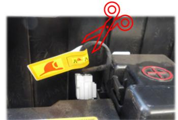
Tagliare il cavo dell'interblocco di servizio per disattivare il sistema HV
