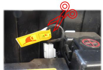
Corte el cable del interlock de servicio para desactivar el sistema HV.
