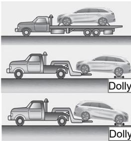
Hinweis: Die Verwendung von Rollböcken oder einer Pritsche wird empfohlen. Verwenden Sie einen Wagenheber oder eine Pritsche.
