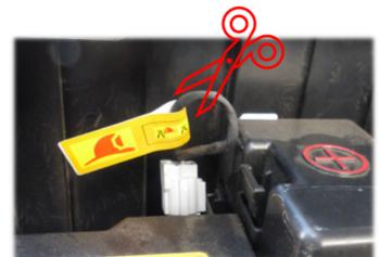
Schneiden Sie das Kabel der Wartungsverriegelung durch, um das HV-System zu deaktivieren.
