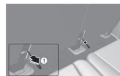
Wenn der Walk-in-Schalter nicht funktioniert, ziehen Sie an dem Gurt (1) links unten am Sitz.
