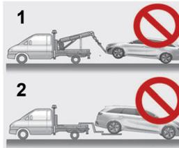
Hinweis: Nicht mit Gurten abschleppen (1). Schleppen Sie das Fahrzeug nicht mit den Vorderrädern auf dem Boden ab, da dies zu Schäden am Fahrzeug führen kann (2).
