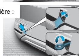
Ouvrez le hayon élévateur et retirez le crochet de remorquage du coffre à outils
