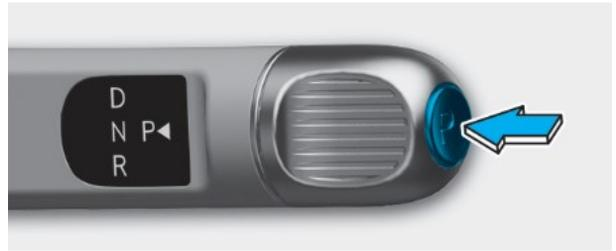
2. Pour les véhicules à transmission automatique, passez la vitesse de stationnement (P).
