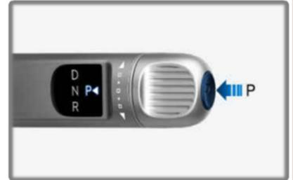
Mettez le véhicule en position P (stationnement) en appuyant sur le bouton « P » sur le levier rotatif
