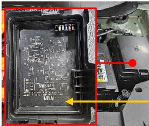
Déposez le couvercle de la boîte à fusibles dans le compartiment de la mise à la terre de protection (PE, Protective Earth). Sous le couvercle, vous pouvez trouver l'étiquette décrivant les noms des fusibles et leurs calibres.
