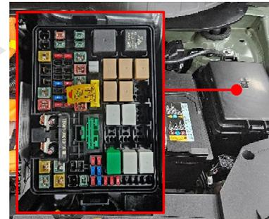
Retirez les fusibles « IG1 » et « IG2 » de la boîte à fusibles du compartiment PE. Utilisez l'outil de dépose (1) fourni dans le couvercle de la boîte à fusibles.
