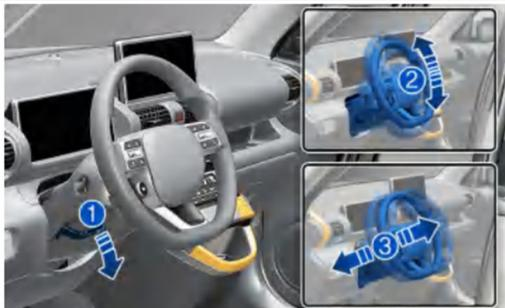
Tire hacia abajo de la palanca de desbloqueo (1).
