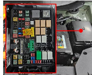
Extraiga los fusibles "IG1" e "IG2" de la caja de fusibles del habitáculo del módulo eléctrico de potencia (PE). Utilice la herramienta de extracción (1) suministrada en la cubierta del panel de fusibles.
