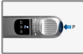
① Calez les roues et tirez le commutateur du frein de stationnement électronique pour serrer le frein de stationnement.
