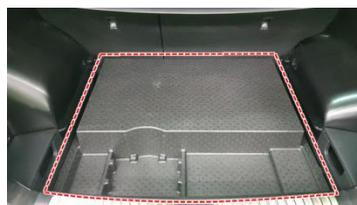
Après ouverture du couvre bagage, retirer le compartimenteur en polystyrène.
