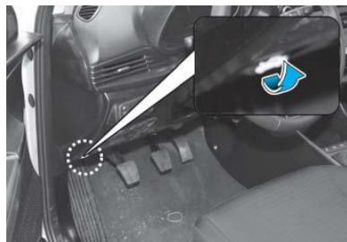
Tirer sur le levier de déverrouillage du capot. Le capot doit s'ouvrir légèrement.
