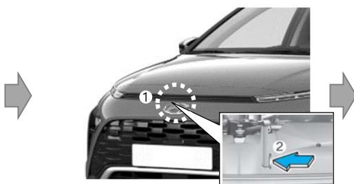
Eleve ligeramente el capó, tire del enganche (1) situado en el interior del centro del capó y levante el capó (2)
