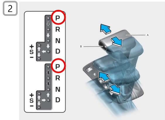
En vehículos con cambio automático: mueva la palanca a la posición P
