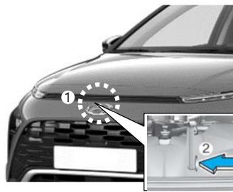
Heben Sie die Haube leicht an, drücken Sie den Fanghaken innen in der Mitte (1) nach oben und öffnen Sie die Haube (2).
