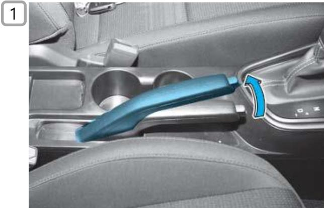
Handbremse so weit wie möglich anziehen
