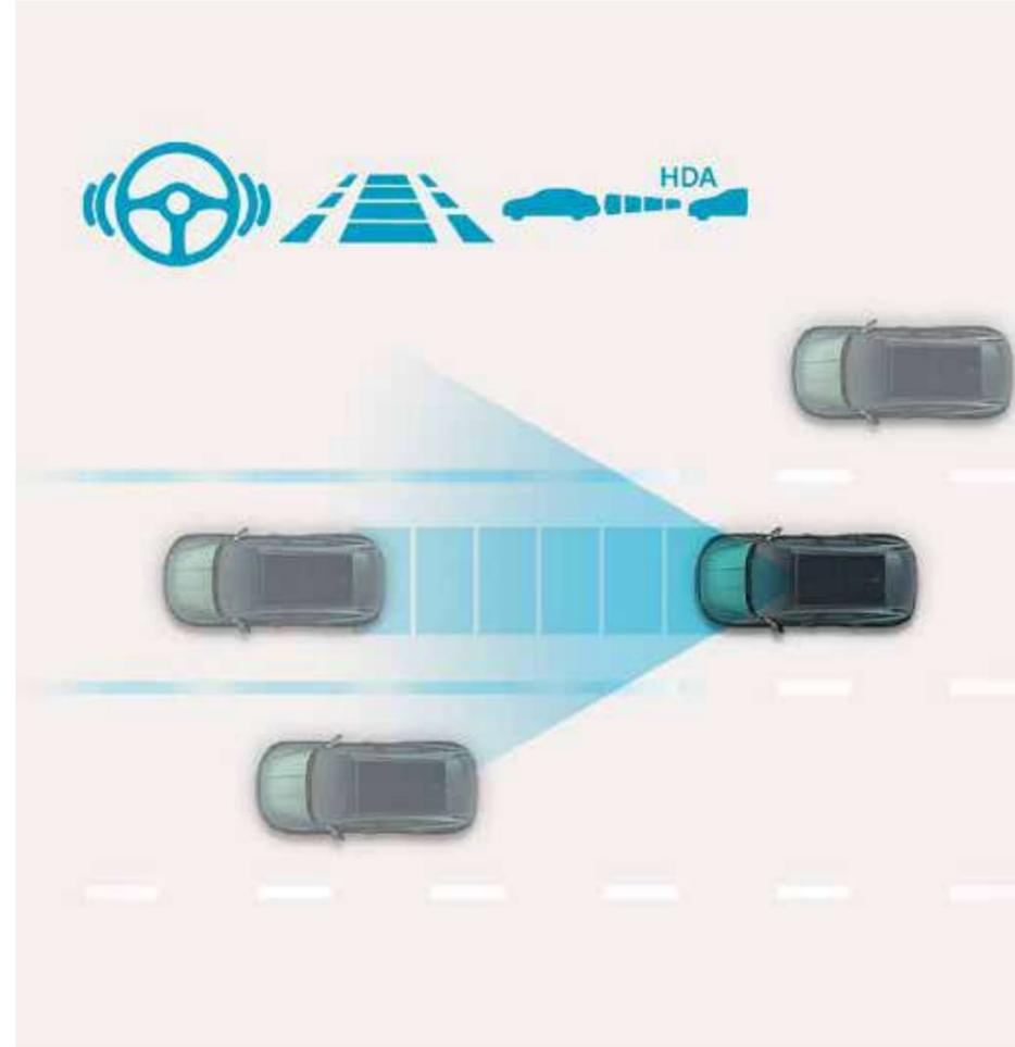
Assistenza attiva in autostrada. L'Highway Driving Assist 1.5 mantiene la velocità e la distanza dal veicolo che precede, aiutando a mantenere TUCSON centrata nella corsia anche in curva.
