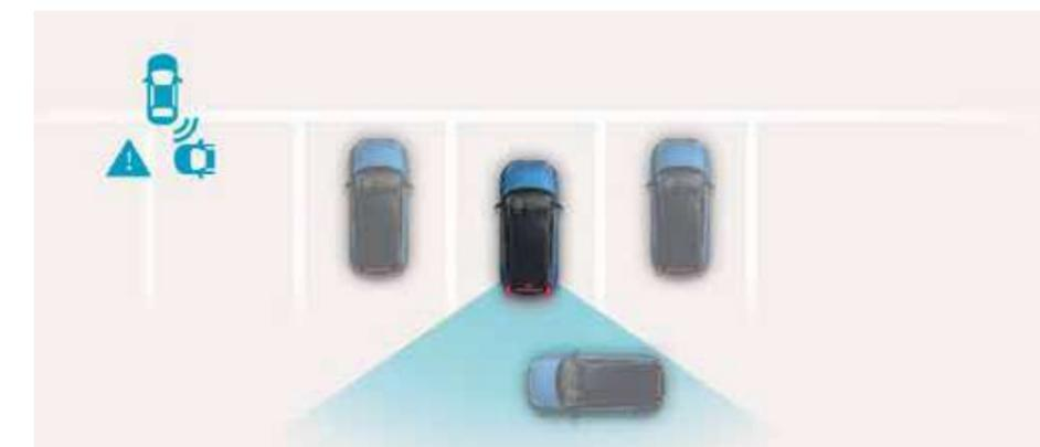
Parking Collision-avoidance Assist - Reverse (PCA-R). Quando parcheggi in retromarcia in spazi ristretti, il sistema rileva il pericolo di collisione e aziona automaticamente i freni per evitare l'impatto.
