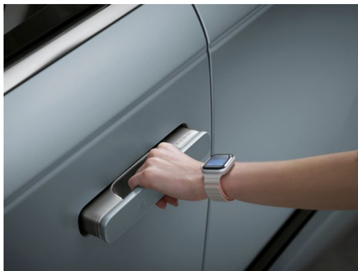
Wysuwane klamki drzwi podkreślają futurystyczny design IONIQ 9 oraz poprawiają aerodynamikę pojazdu ( C_d=0.259 ).
