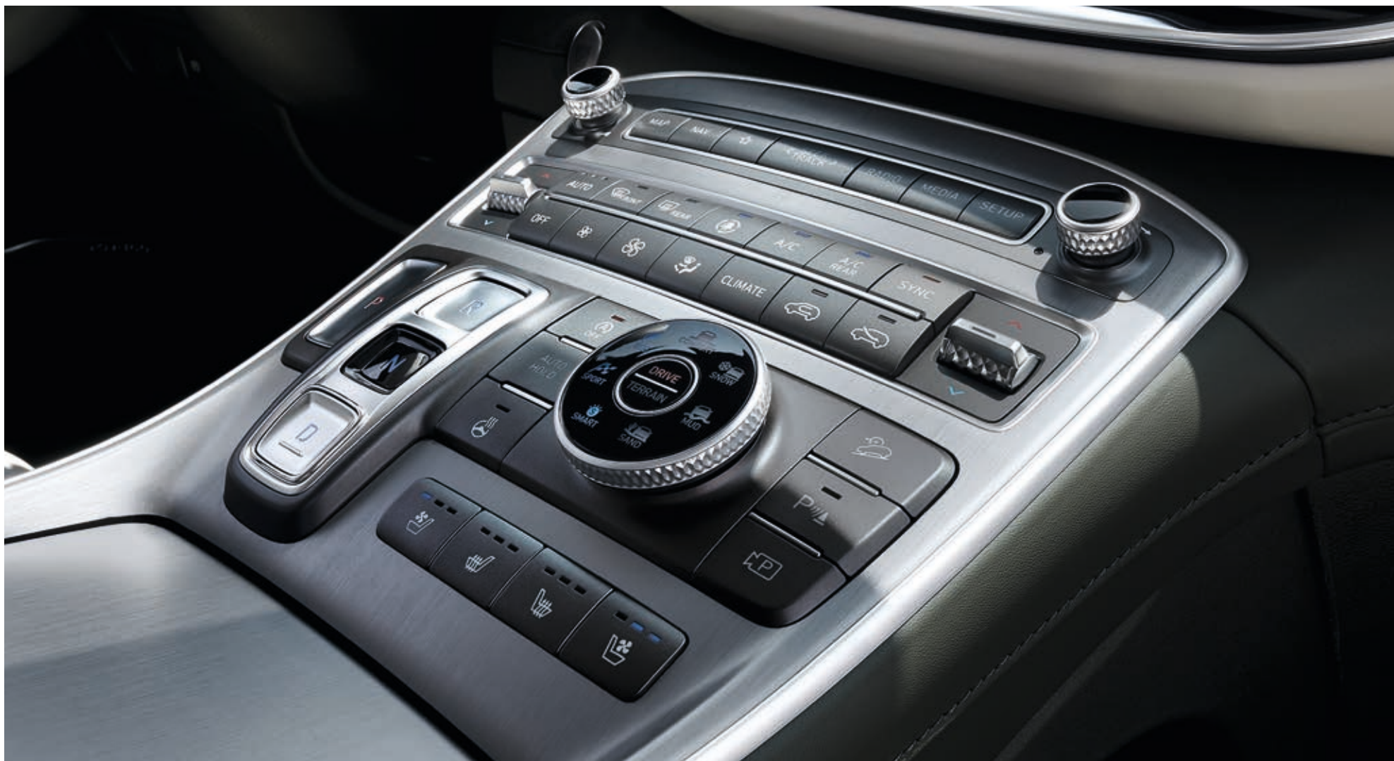
Consola central tipo puente y cambio automático por botones (Shift by Wire)
