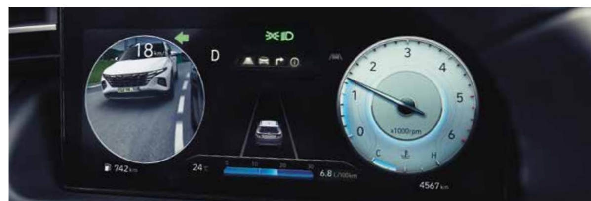
Surround View Monitor (SVM) Goditi la visibilità a 360° per parcheggiare in modo più facile e sicuro. 4 telecamere ad alta definizione montate sulla parte anteriore, laterale e posteriore del veicolo ti mostrano l'ambiente circostante in tempo reale.
