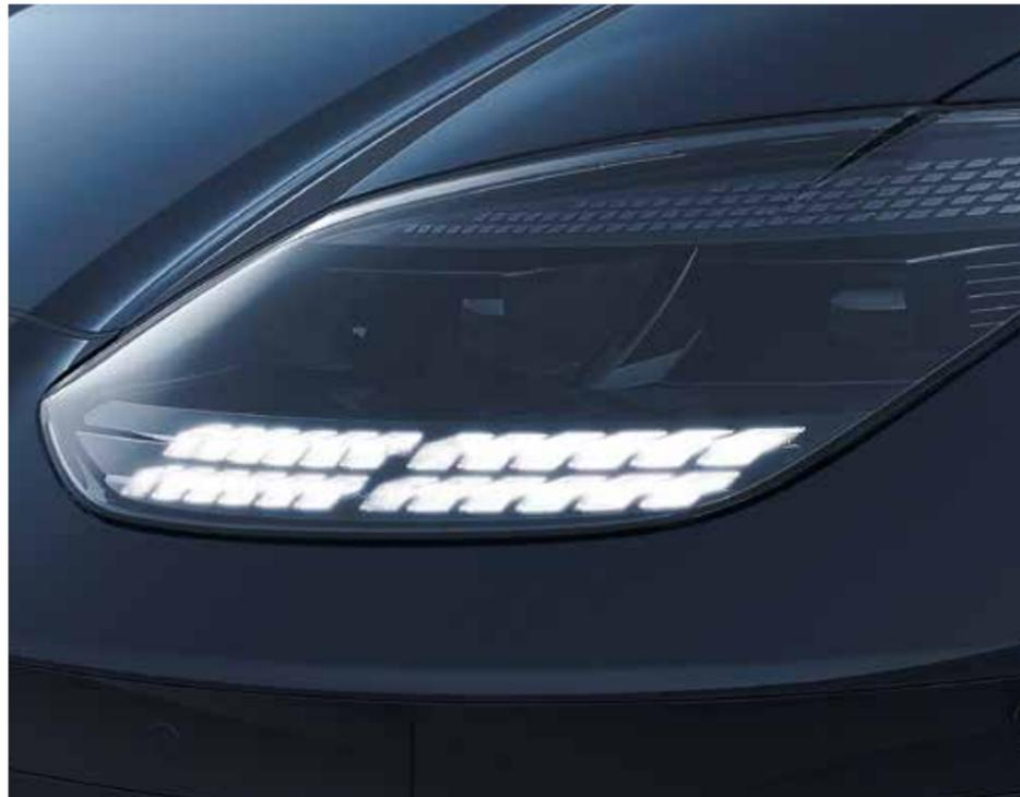
Dotato di tecnologia LED a fascio di luce Matrix e di luci diurne a pixel parametrici, il sistema di illuminazione anteriore intelligente si adatta automaticamente alle situazioni stradali, ottimizzando l'uso dei fari di profondità senza il rischio di abbagliare i conducenti che sorraggiungono in senso contrario.
