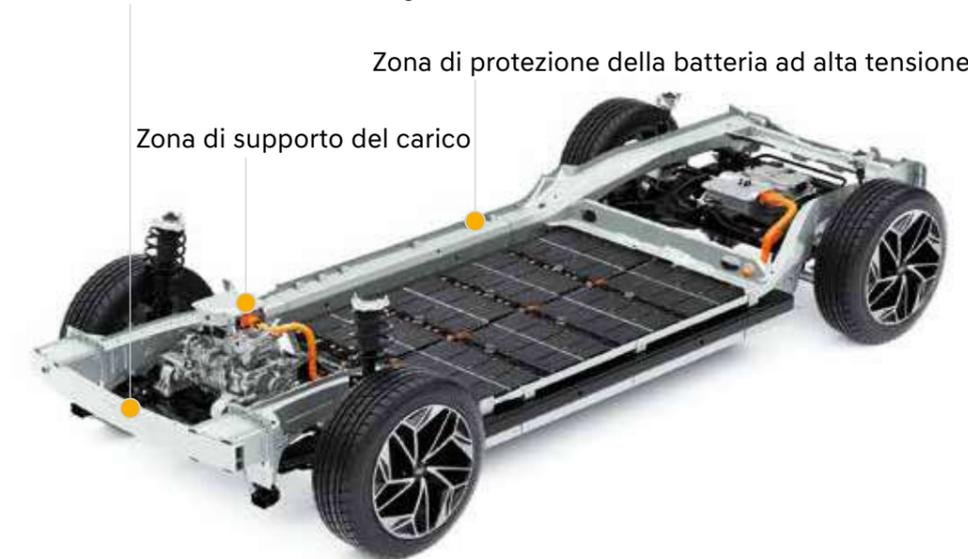
La struttura multi-telaio e le nuove tecnologie di sicurezza lavorano all'unisono per proteggere i passeggeri e la batteria. Una zona di assorbimento dell'energia di collisione disperde le forze d'urto lungo percorsi di carico energetico nella zona di schiacciamento, le cui strutture sono progettate per deformarsi in modo prevedibile, attenuando così l'energia d'impatto e proteggendo gli occupanti dell'abitacolo e la batteria da 800V.
