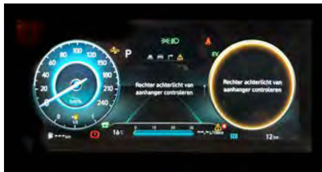
2. 7- of 13-polige trekhakabelset met foutmeldingscontrole
