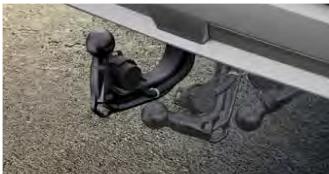
1c. Wegklapbare trekhaak (semi-elektrisch)
