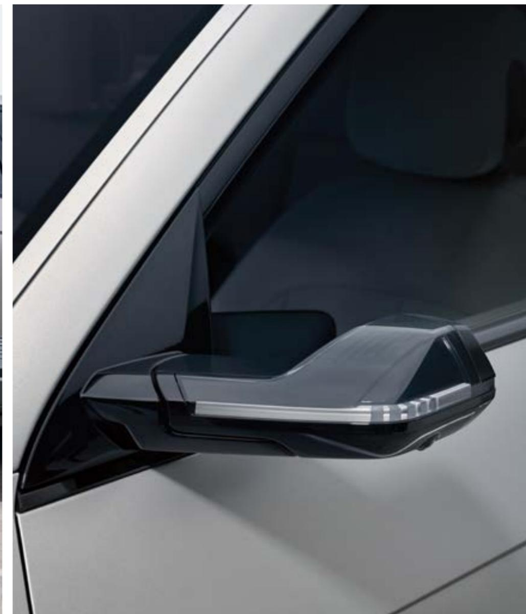
**Specchietto retrovisore digitale aerodinamico (DSM)**
