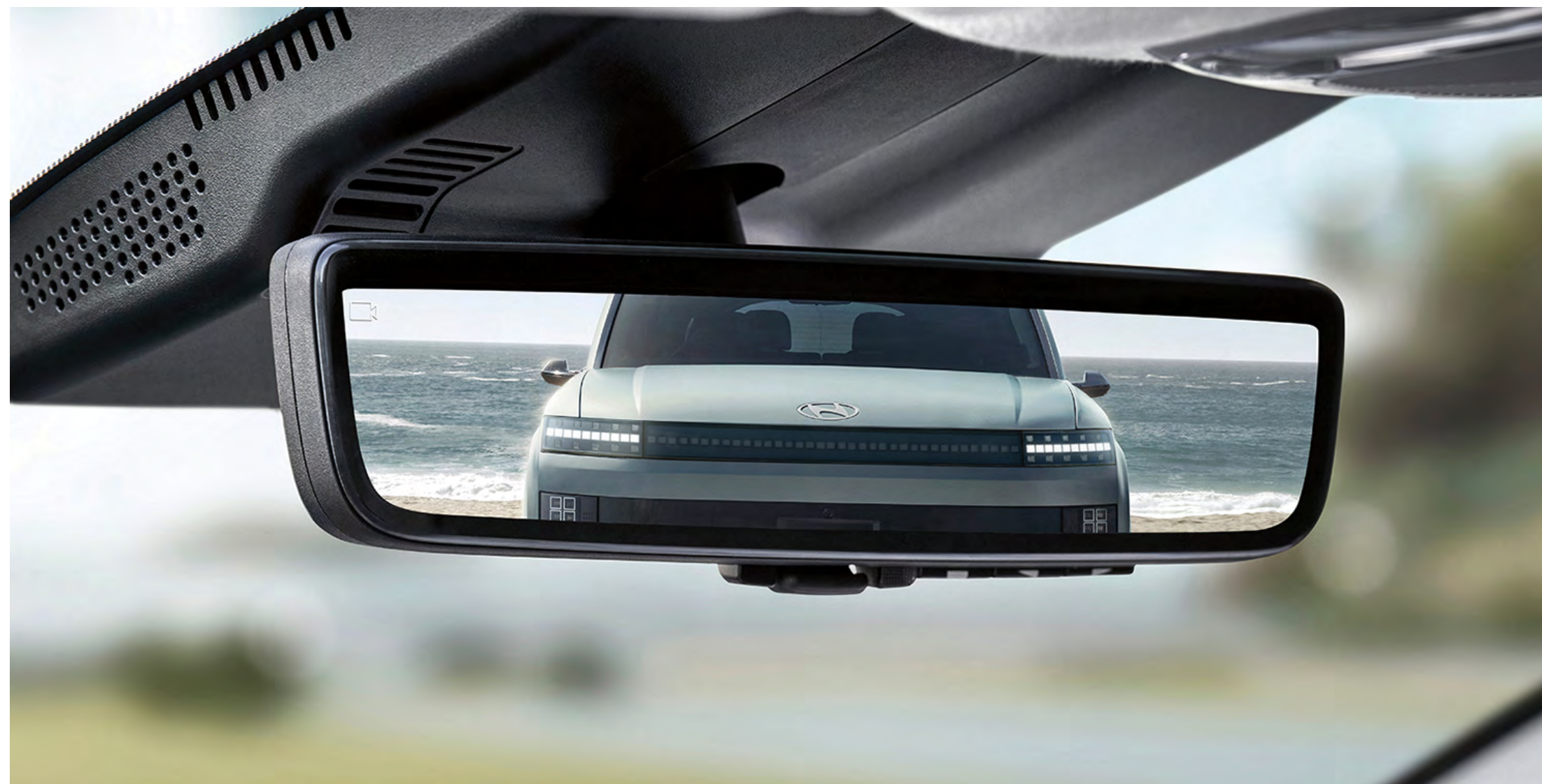
När den aktiveras visar den digitala innerbackspegeln en realtidsbild från en bakmonterad kamera, för ett betydligt bredare synfält.
