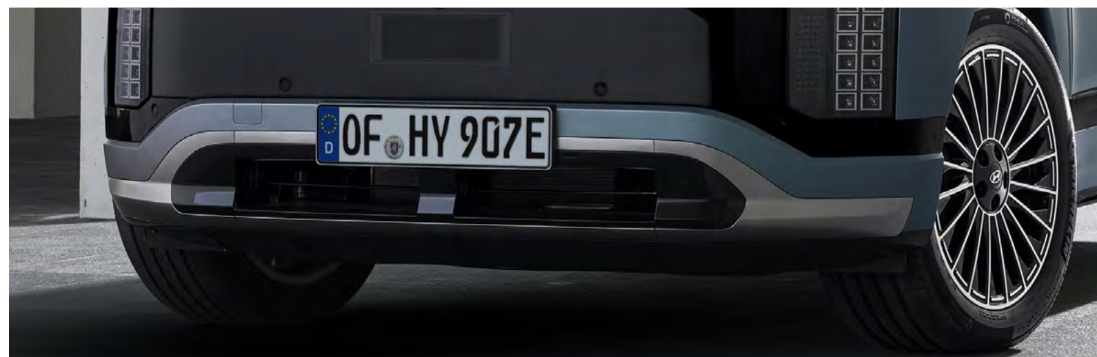
Aktiv luftintagslucka med dubbelfunktion som förbättrar aerodynamiken och ger ett slankare uttryck.
